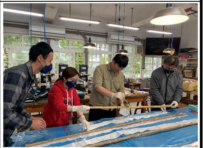
將船帆結構上玻纖，加強硬度
