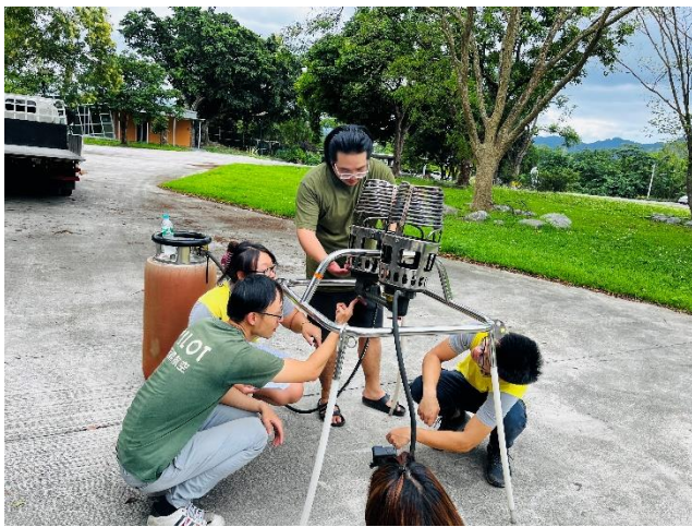
說明:燃燒器檢測
